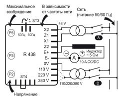
Статическая настройка ограничения тока, потенциометр (заводская установка: 7,5 A, тип предохранителей: 8 A - 10 секунд).
