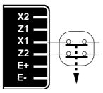
Снятие возбуждения происходит при прекращении питания регулятора (1 провод – X1 или X2) с контактами типа 16A - 250B переменного тока.
