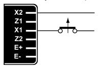
Снятие возбуждения происходит при прекращении питания регулятора (1 провод – X1 или X2).
